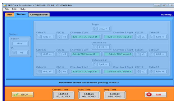
Figura 2 La schermata del programma di acquisizione da cui è possibile dedurre la posizione della sinistra e della destra del telescopio.
