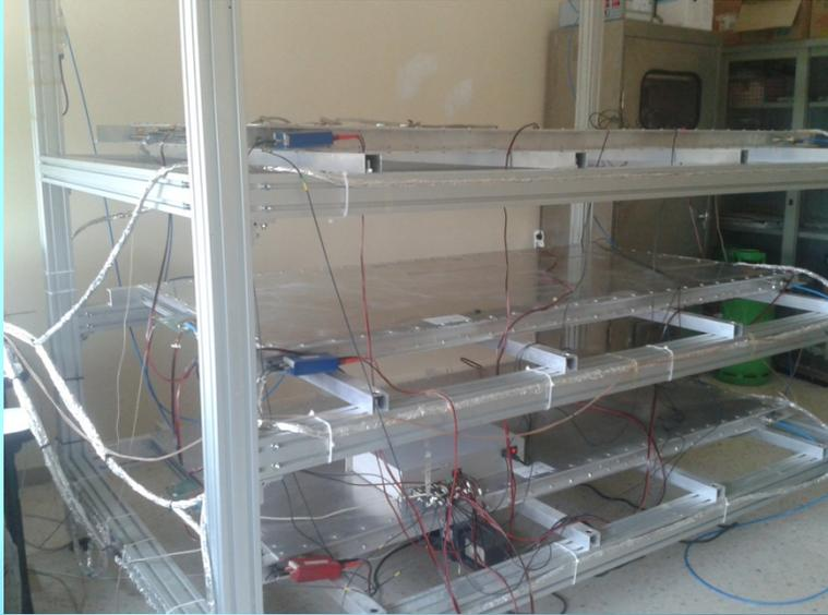
Ogni telescopio è costituito da tre camere MRPC (Multigap Resistive Plate Chambers)
