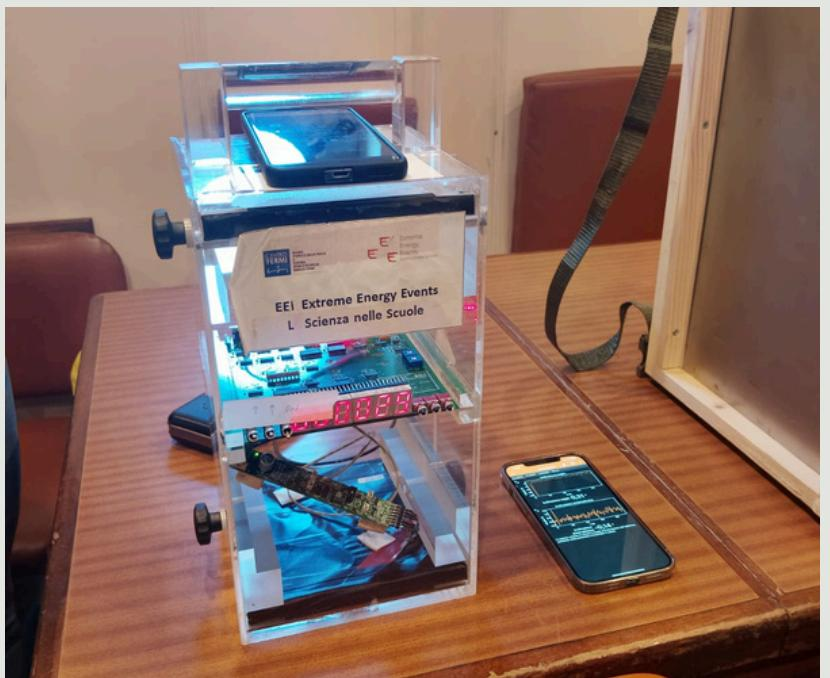
Misurazione con telefono per la misurazione dell'inclinazione rispetto all'orizzontale
