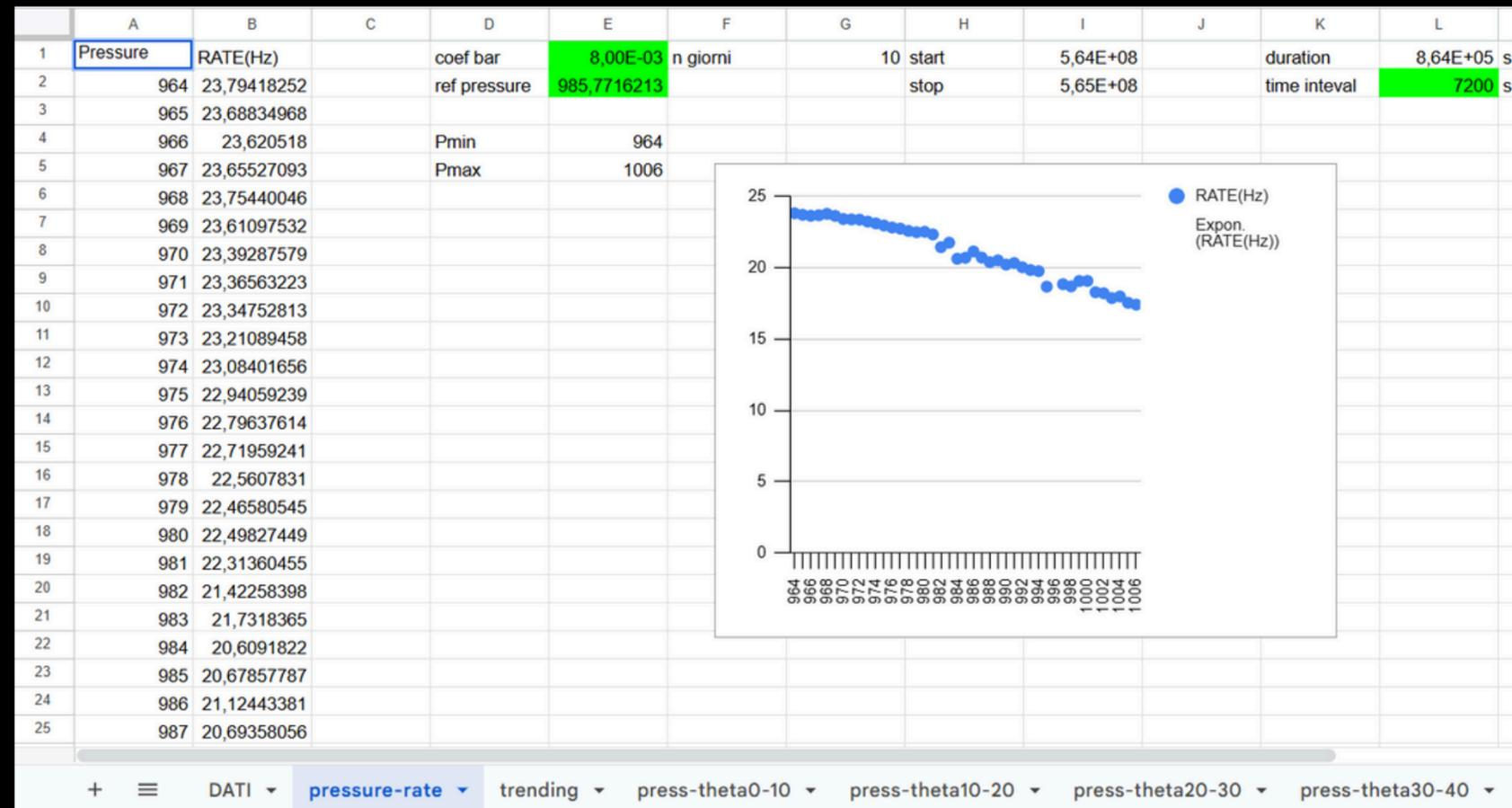
In questa tab sono processati i dati della prima tab per costruire un grafico Rate vs Pressione. Il coefficiente barometrico è impostato a partire dal risultato del fit esponenziale mostrato nel grafico
