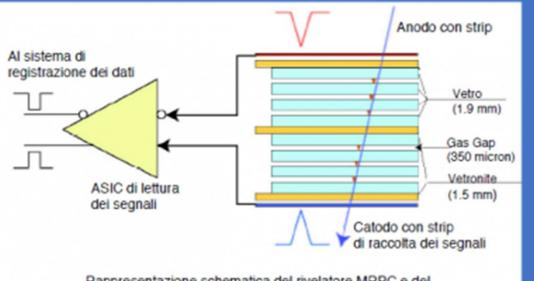
Rappresentazione schematica del rivelatore MRPC e del suo sistema di lettura e acquisizione dei dati.
